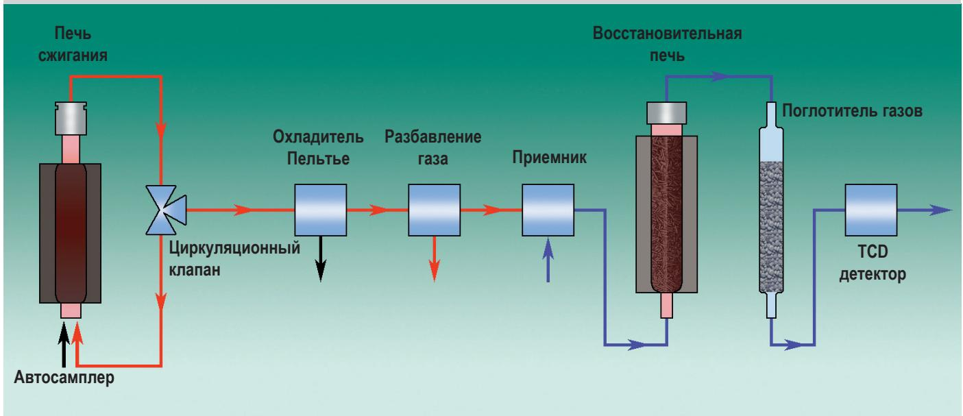
Анализ на приборе Primacs<sup>SN</sup> общий азот/протеин выполняется в несколько шагов:
