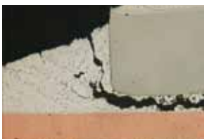
Поперечный срез пайки (1000x)
